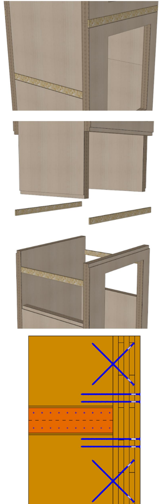
Image 26, assemblage du module en longueur
