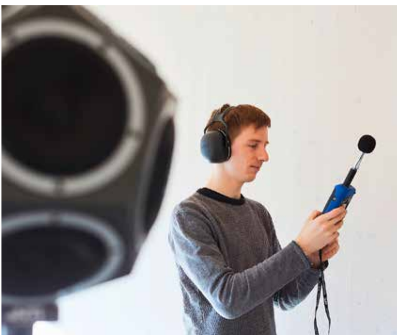
Dem akustischen Verhalten von Holzbaukonstruktionen auf der Spur: Schallmessung in einem Holz-Mehrfamilienhaus in Bümpliz.
