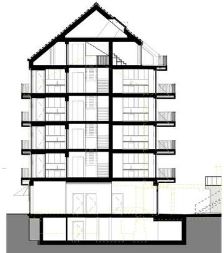
»Der Kern, die Geschossdecken und die Brandmauern sind in massiven Brettsperrholzplatten erstellt und gewährleisten die Aussteifung. Die Fassaden sind in Skelettbauweise erstellt und bieten so eine maximale Flexibilität für zukünftige Veränderungen.«
