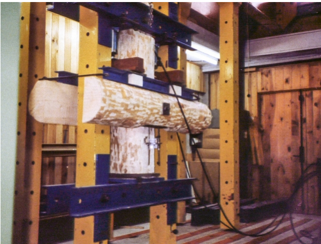
Développement et test de la pièce de raccordement pince-poteau...
