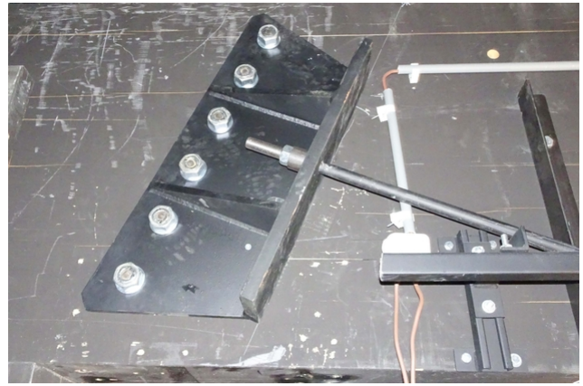
Fixations des barres de traction au moyen d'une plaque en acier
