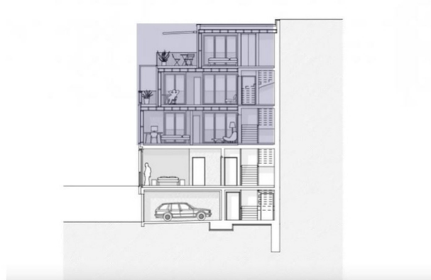
Querschnitt der Aufstockung
