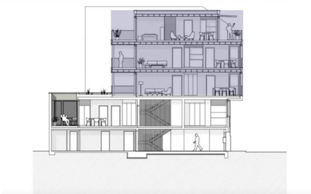
Längsschnitt der Aufstockung
