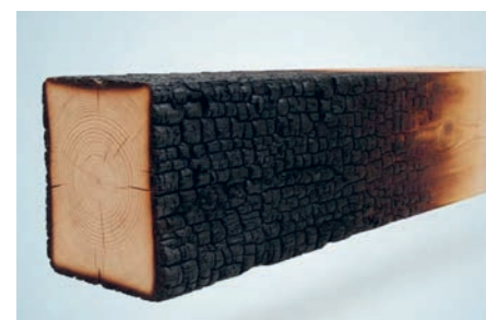
Représentation de la couche de carbonisation sur une poutre d'essai de résistance au feu
